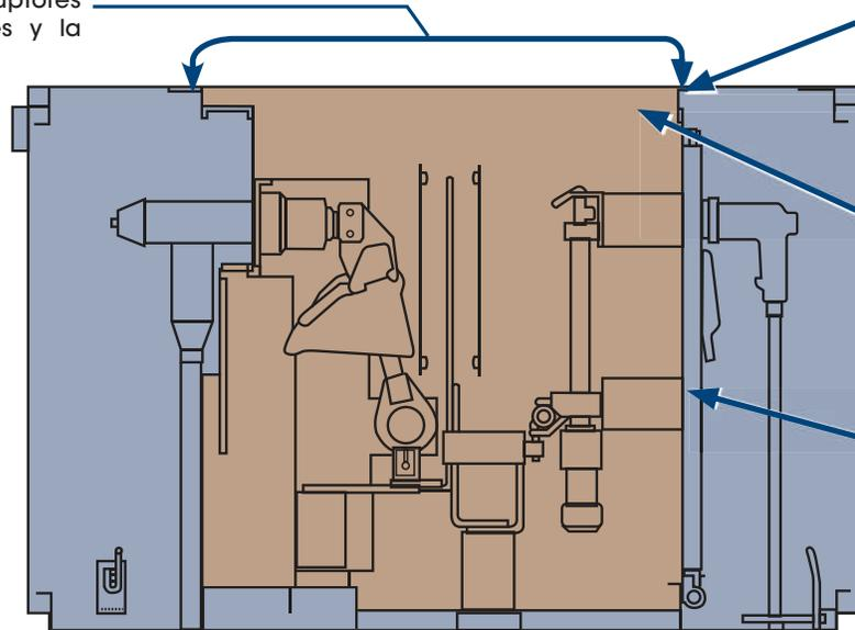
El empaque elástico sella la cubierta superior con las mamparas del compartimento y con las paredes del gabinete
